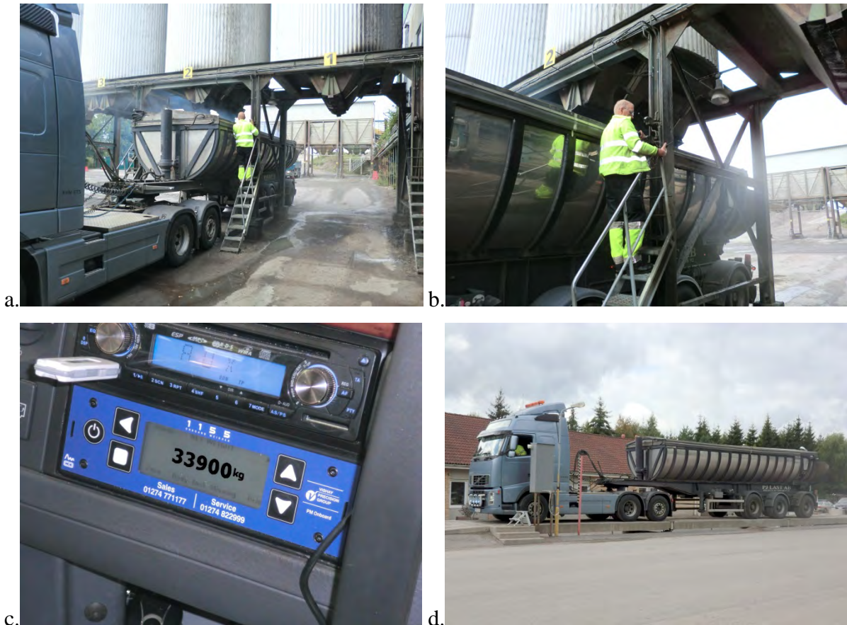
Bild 4-1 Trailerbilen lastades först framtill (a.), därefter baktill till full last, vilket kontrollerades med handburen display (b.) och bekräftades på den fasta displayen i förarhytten (c.) Värdena jämfördes sedan med vägning på en krönt utlastningsvåg (d.).
